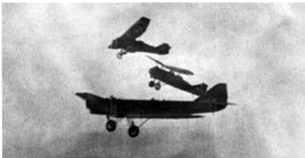
Фото 7. Отделения истребителей от самолёта-носителя ТБ-1
